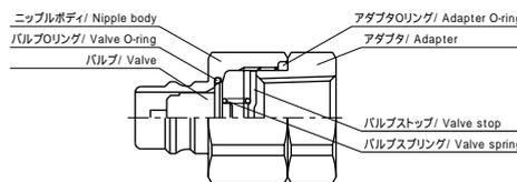
開閉式バルブ機構を備えたタイプです。 It is a type having open-shut valve mechanism.
