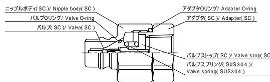
残圧下での接続が可能なPHバルブ機構を採用しています。7.0MPaの残圧下でも17.7Nで接続できます。
