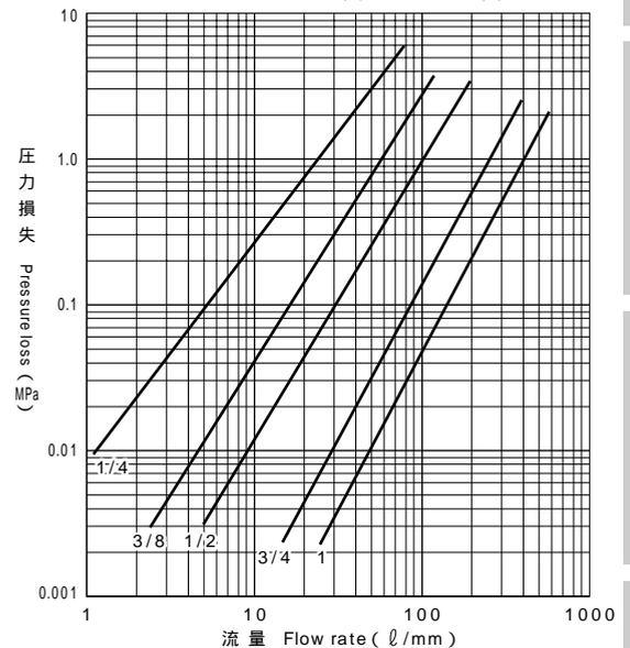
試験条件 流体: ISO VG 32 (タービン油) 温度: 40 粘度: 32c.s.t
