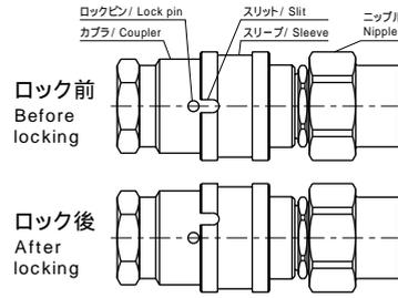
スリーブを回転させ、スリットをロックピンから遠ざけることで、使用中の接続をより確実なものにできます。
